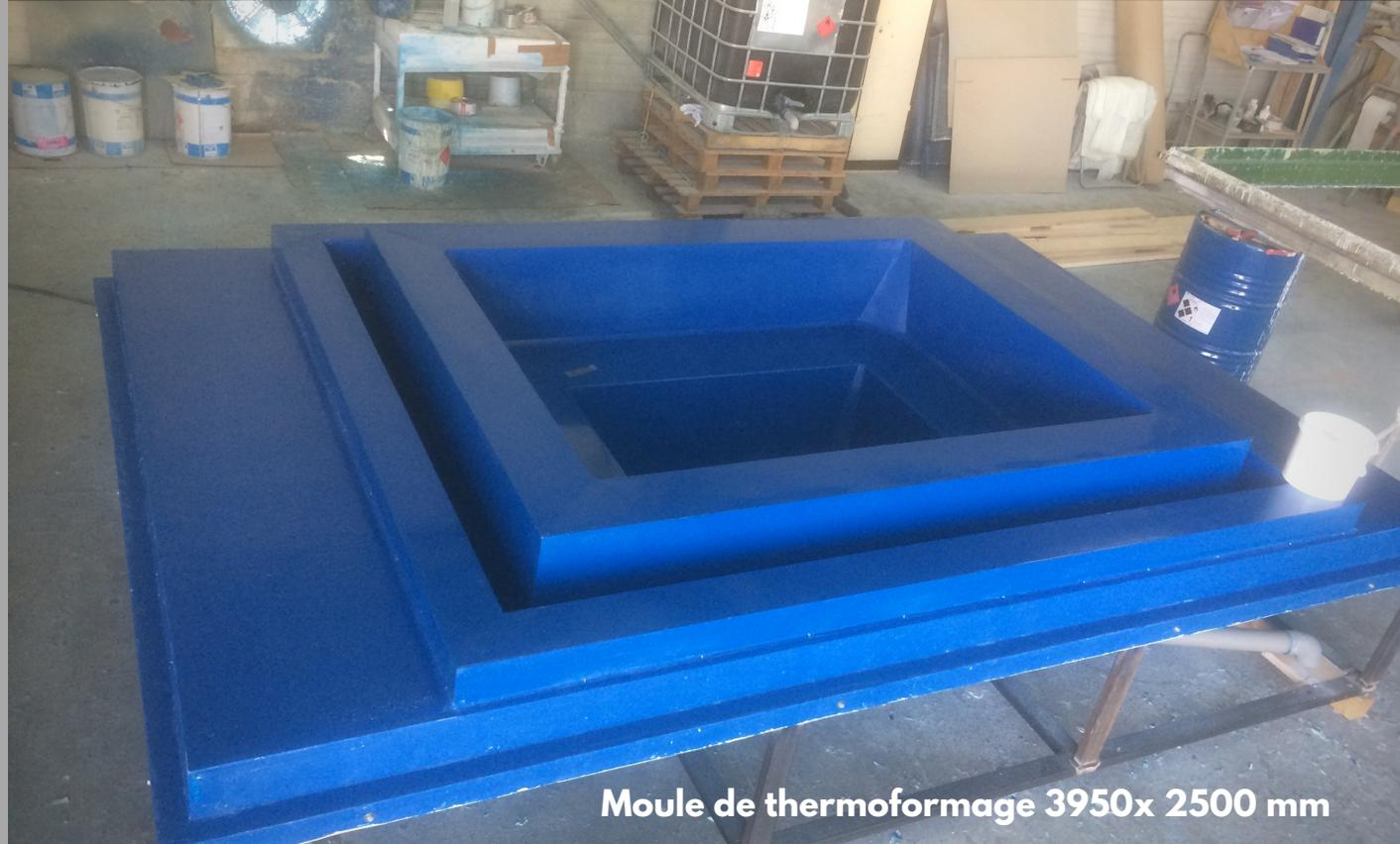
Moule de thermoformage 3950x 2500 mm
